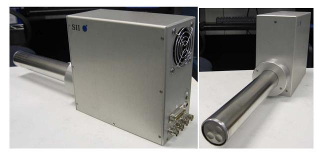
*Figure 2. Vortex-ME4*<sup>TM</sup> *SDD package.*
